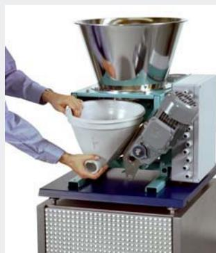
Простой и быстрый демонтаж и сборка соприкасающихся с материалом деталей для смены материала и очистки с обратной нерабочей стороны являются особыми преимуществами системы дозирования MechaTron®.
